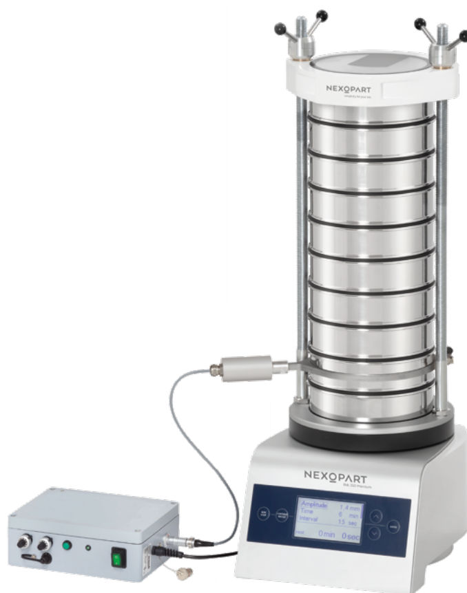
Systeme d'ultrasons avec variation de fréquence AGS, avec bague de serrage et convertisseur sur la tamiseuse de laboratoire EML 200 Premium
