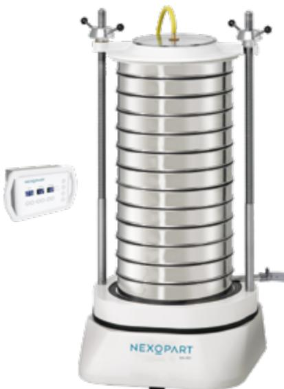
Die **EML 450** ist das Schwergewicht unserer EML-Serie und wählbar für die Nass- oder Trockensiebanalyse. Mit bis zu 15 kg Aufgabemenge bietet sie die größte Analysefläche und ist ideal für Analysensiebe bis 450 mm Durchmesser. Die EML 450 für die Nasssiebung unterscheidet sich von der Version zur Trockensiebung durch einen Deckel mit integrierter Bündelsprühdüse sowie weiterem Zubehör für die Nasssiebung. Beide Maschinentypen verfügen über eine separate Steuereinheit.
