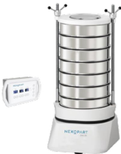
Die **EML 315** ist in der Ausführung für die Nass- oder für die Trockensiebanalyse erhältlich. Sie können die Maschine für verschiedene Siebe mit einem Durchmesser bis 315 mm einsetzen. Die EML 315 für die Nasssiebung unterscheidet sich von der zur Trockensiebung durch einen Deckel mit integrierter Bündelsprühdüse sowie weiterem Zubehör für die Nasssiebung. Beide Maschinentypen verfügen über eine separate Steuereinheit.
